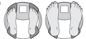
Fersen mittig auf Elektroden Zehen können über Plattform hinausragen
