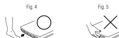
Para recalibrar la báscula, presione la tecla personal con el dedo de un pie (vea la Fig.4). No ponga la mano sobre la báscula (pesa) mientras está efectuando la recalibración (vea la Fig.5), pues si lo hace, entonces la pantalla mostrará "-2.0" o "-0.4". Utilizando el dedo de un pie, vuelva a presionar la tecla personal para que la pantalla muestre "0.0".
