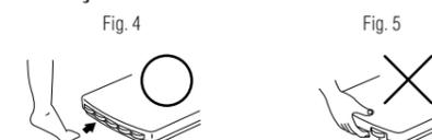
Para recalibrar a balança, pressione suavemente e solte rapidamente a sua tecla pessoal, com o dedo dos pés. (Vide Fig.4). Não coloque a mão na balança enquanto se efetua a recalibração (Fig.5), porque se você fizer isso, o mostrador indicará "-0.2" ou "-0.4". Usando o seu dedo dos pés, pressione novamente e solte rapidamente a sua tecla pessoal, até que apareça "0.0" no mostrador..
